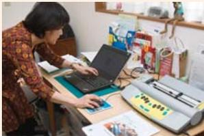
パソコンで入力し、点字に変換された文章を、右側の機械でシートに出す
